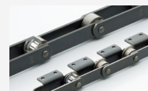
転がり軸受構造により、省エネと長寿命化を実現したベアリングローラコンベヤチェーン（1985年）
