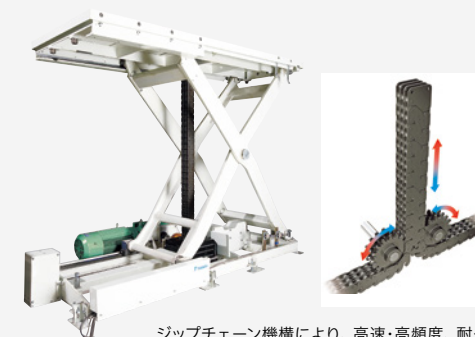
ジップチェーン機構により、高速・高頻度、耐久性を実現したジップチェーンリフタ(2008年)
