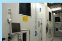
世界初-150°C超低温対応の創薬用小型冷凍保管庫ラボストッカ150 (2016年)
