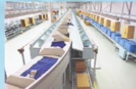
リニアモータ駆動の自動仕分け装置・リニソート (1992年)
