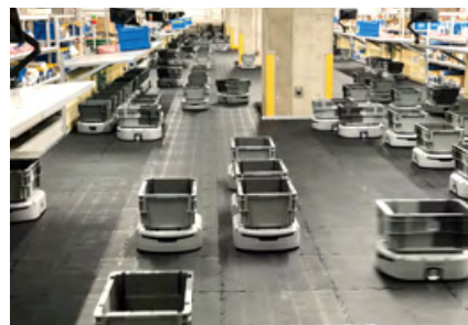
物流センターで稼働する小型AGV
