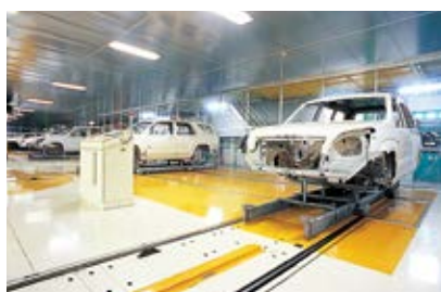
■ 自動車製造ライン搬送システム
