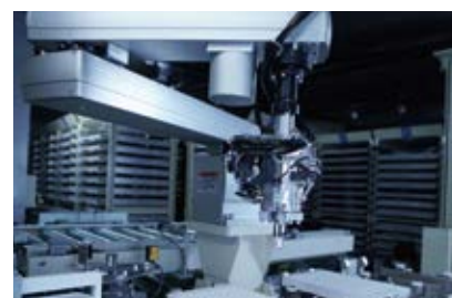
■ ライフサイエンス分野向け超低温自動保管庫 (つばきラボストック®)
