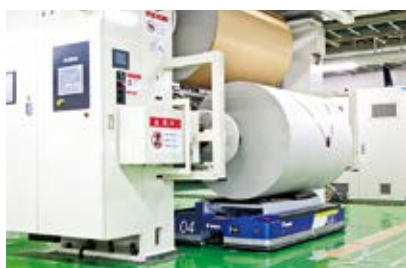
■ 新聞印刷工場向け給紙AGV
