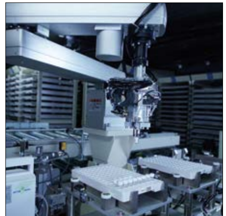
ライフサイエンス分野向け超低温自動保管庫「つばきラボストック®」
