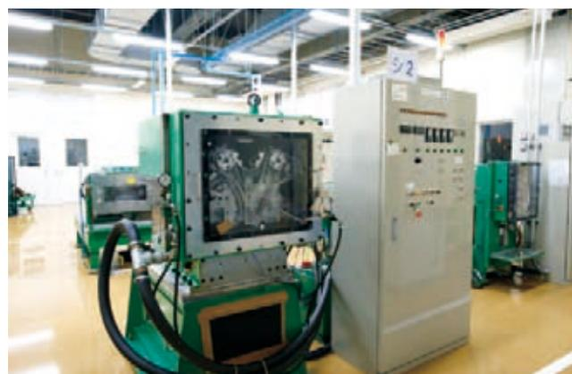
オートエンジニアリングラボ（タイミングドライブシステムシミュレータ）
