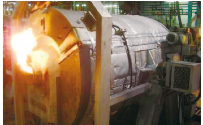
大型レトルト炉への断熱ジャケット取り付け
