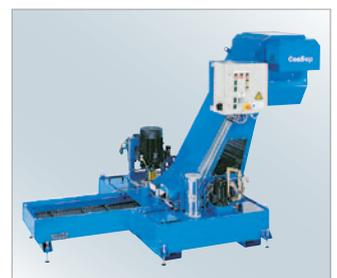
金属屑搬送・クーラント処理装置
