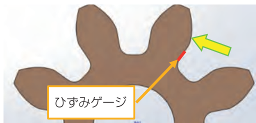
図16. 歯にかかる力と歯元変形を検出するひずみゲージ
