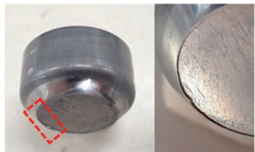
図7. 据込み2加工後下面外観および「バリ」 (改善前)
