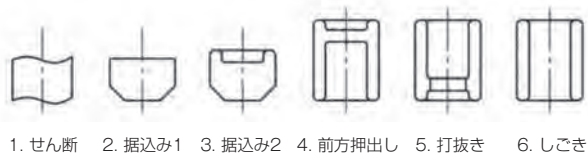
図3. 改善対象品の鍛造工程 (簡略図) ※「2から3」「3から4」「4から5」は反転している
