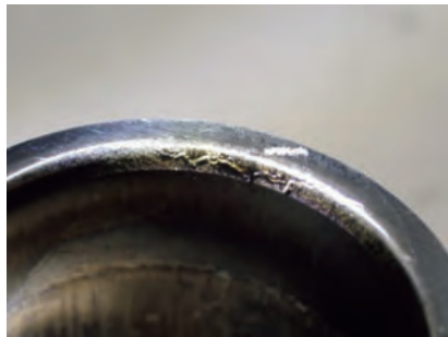
図4. 冷鍛部品に発生したキズ (改善前)
