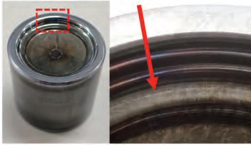
図13. 前方押し出し外観と最終バリ位置（改善後） ※矢印部分の線状キズが最終バリ位置である。
