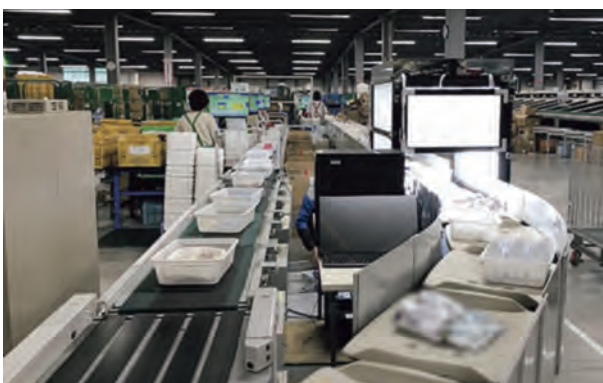
「AI 画像認識技術」を活用した「AI てむ鑑定士 ® 」(右奥の白い筐体)と自動仕分け装置「リニースト ® 」をシステム統合した物流支援ソリューションの導入例
