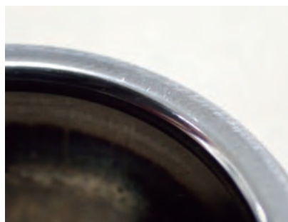
図12. 内径面取り部分（改善後）
