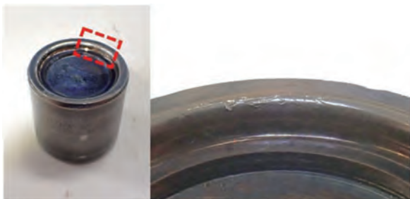
図5. 前方押出し外観および内径面取りの「キズ」
