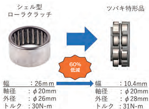
図9. シェル形ローラクラッチとカム&ローラの幅比較
