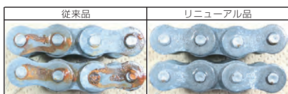
図8. 水酸化ナトリウム水溶液浸漬・塩水噴霧試験結果
