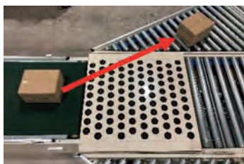
図2. クイックソートを用いた仕分けシステム
