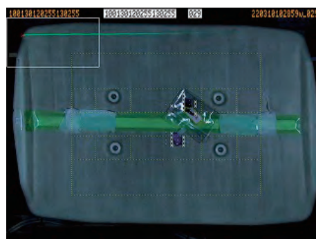
図 18. 名札入れの検出（左：比較元画像）、（右：検出画像）小さなクリップ部と鏡面反射部検出
