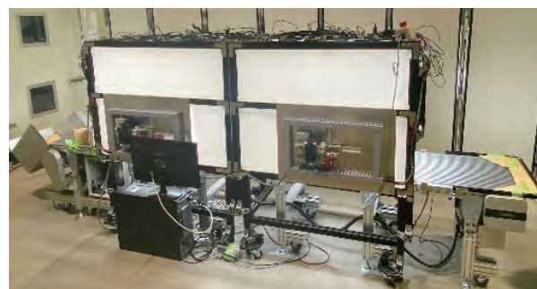
図 11. コンベヤ撮像装置
