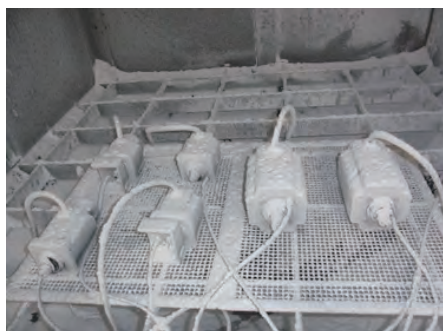
図1. IP6Xの試験の様子
