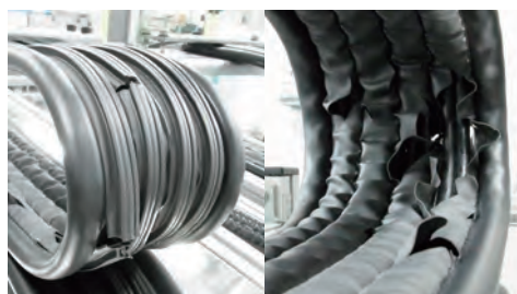
図5. 開閉チューブ（市販品）破れ
