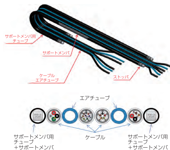
図1. 従来のフラットベヤの構造
