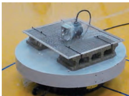
図2. IPX5の試験の様子
