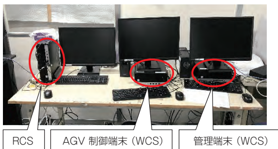
図 4. オペレーションルームの機器配置
