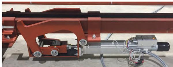
図4. 電動化例(電動ストッパ)
