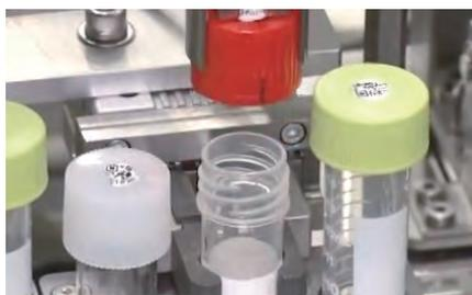
図 1. 検体チューブ（容器）開栓の様子
