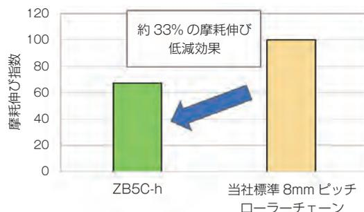
図 1. チェーン摩耗伸び性能比較
