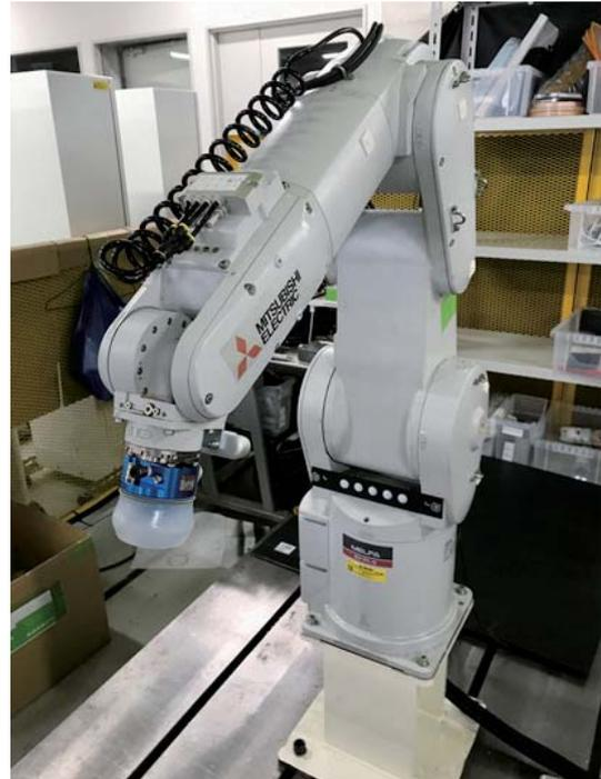
図8. 装置の写真 ハンド、3次元カメラ、ロボット
