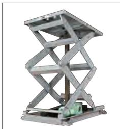
ジップチェーン駆動のテーブルリフタは、油圧式と比較し耐久性、高タクト運転、優れた停止精度を実現。従来のストローク1mに加えストローク1.6mのラインアップを拡大し、従来形リフタが抱える課題を解決。
