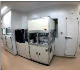
ラボストックカ80の機能拡張型シリーズ商品。検体の前処理工程から保管までを全自動化。検体処理の履歴と時間を品質記録化して閲覧可能にしたことで、研究品質向上に寄与。
