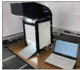
AIによる物体認識を体感できるデモシステム。落下する商品を撮影、認識、結果表示することで「物体認識」の高速で高精度な識別を直観的に体感可能。
