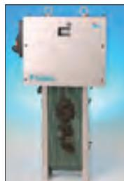
タンク内自動スラッジ回収装置。マグネット式タンク内スラッジ回収装置として好評のスラッジバリヤの機種拡大版。モータ駆動により自動でベルトに付着したスラッジ(磁性体)を自動回収、内蔵タイマー設定で浮上油の回収も自動化。
