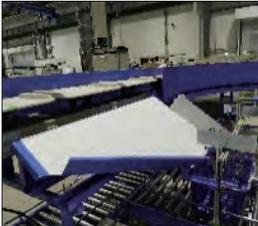
チルトトレイ式ソータリニソートS-Eと組み合わせて使用されるシュートに空ケースのセット、ケース内満杯の検出、満杯ケースの搬出を全自動にして無人化を実現。
