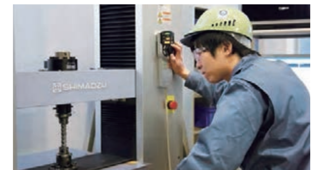
チェーンの破断強度検査
