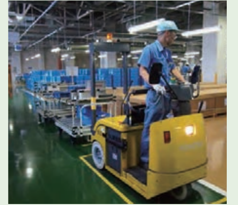
各工程への部品供給・完成品回収を担当する 「水すまし」
