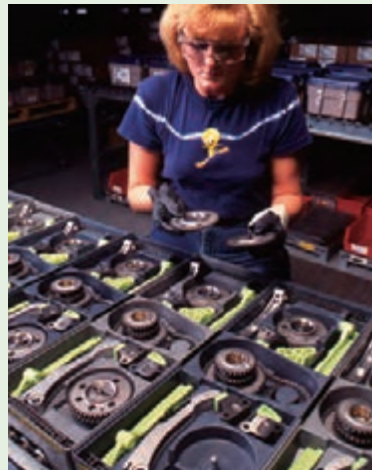
タイミングチェーンドライブシステムの納品前チェック (GM社向け)
