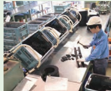
ケーブルベヤ組立ラインでのセル同期生産
