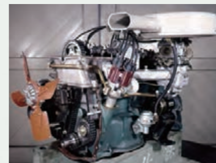
自動車エンジンに装着されたタイミングチェーン
