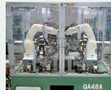
ケーブルベヤ組立ロボット
