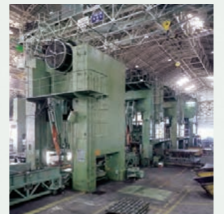
プレス間のワーク移載装置「アイアンハンド」
