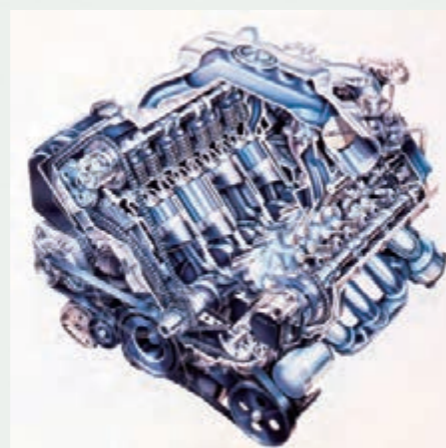
GM車に採用された タイミングチェーンドライブシステム
