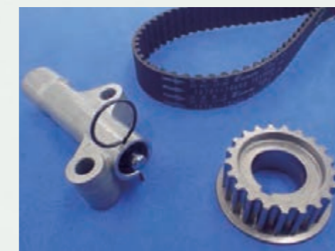
タイミングベルトドライブシステム構成部品 (オートテンショナ、タイミングベルト、プーリ)
