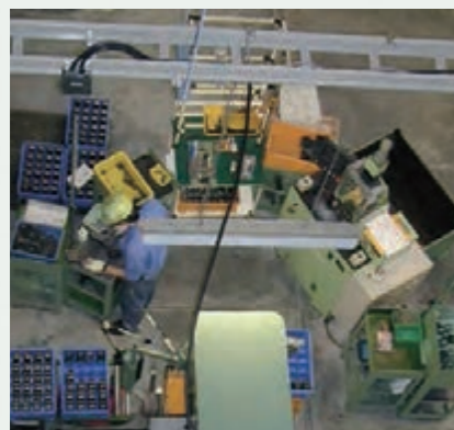
ATCチェーンのセル生産ライン
