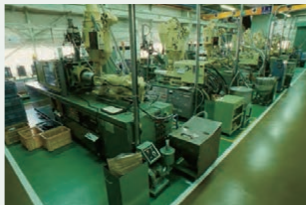
射出成形機が並ぶ、小形チェーン工場
