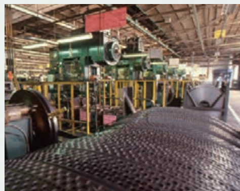
月産100万本を達成したタイミングチェーンの製造工程
