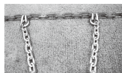
「ねじれ」が取れた正常な状態
