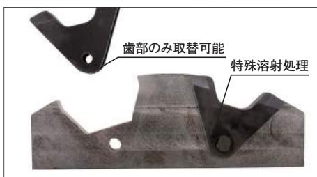
スプロケットの歯部のみを取替可能とし、さらに歯底部に特殊溶射処理を施しています。
