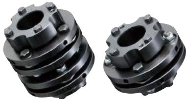
サーボモータの特性を最大限に活かせる、ノンバックラッシングで高いねじり剛性を有した無潤滑のカップリングです。有限要素法に基づく最適形状のディスクは確実にトルクを伝達しながら、しなやかにミスマライメントを吸収します。
