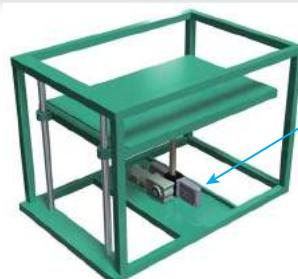
組立作業の生産性向上の為、部品棚を作業者の腰の高さに位置決めする装置にジップチェーンアクチュエータ、パワーシリンダが使われています。
