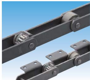
つばきペアリングコンベヤチェーンは、ローラにニードルペアリングを内蔵するため、ローラの転がり抵抗が小さく、さらに搬送距離が長い場合には省力化が実現できます。またその速度が遅い場合でもシャクリ現象が発生しにくい特長があります。
