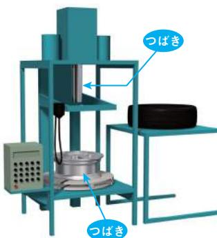
タイヤとホイールの組付け箇所にタイヤの側面固定用で位置決め精度が高く調整不要のパワーシリンダが使われています。また昇降装置にも使われています。
