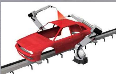
上塗は、塗装ロボットやレシプロ式塗装機で、実際のクルマの色を吹付け塗装をして、ムラなく綺麗に仕上げます。レシプロ塗装機には、つばきドライブチェーンと減速機が使われています。
