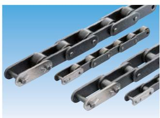
一般用A系ローラチェーンのピッチを2倍にし、プレートをフラット形状とし、アタッチメントを付けた搬送用チェーンです。全長精度が高く、ローラ形式にはRローラとSローラがあり、用途に応じた使い分けができます。
