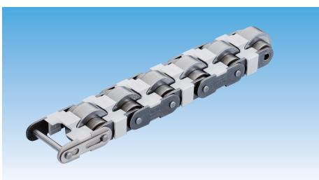
小径ローラと大径ローラを組合せた独自の構造により2.5倍の高速搬送を実現します。
