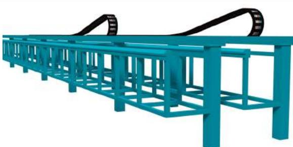
部品の高速搬送させるガントリローダの支持案内装置にケーブルベヤが使われています。
