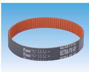
連続稼動で高頻度の衝撃負荷があるサーボプレスで求められるベルトは、高剛性、高強度（ウルトラ PX ベルト HC 仕様比：約 2 倍）である事から、HY 仕様が使われています。これにより装置のサイズダウン→コンパクト化が可能となります。
