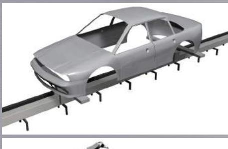
中塗は、ボディー表面を滑らかにして色落ちを無くす為、灰色塗装を塗装ロボットで万弁なく吹き付けします。多軸ロボットの電線支持用につばきケーブルルベヤが使われています。
