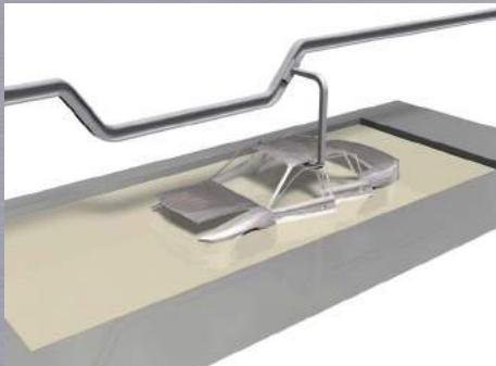
ボディの下塗は、防錆効果のある電着塗装のためボディを天井から吊り、「塗料」の入ったプールの中を潜らせ搬送します。
