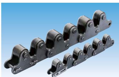
トップローラ付チェーンはバイピッチまたはRS形ローラチェーンのプレートを上部に延ばし、そこに自由に回転するトップローラを取り付けたフリーフロー チェーンです。トップローラに硬質クロムメッキ+バフ処理した仕様などあり、ワークや雰囲気に合わせた選定が可能です。
