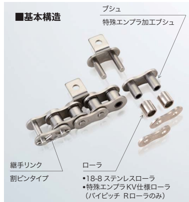
(左)LSK®仕様 基本構造 (右)つばきコーティングチェーンNEP仕様カタログ
