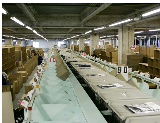
紳士服物流センター（直線式により、省スペースを実現）
