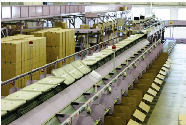
婦人服物流センター（入荷検品、店舗別仕分け、箱詰め、出荷までのすべての工程でリニソートが稼働）
