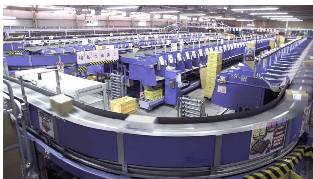
化粧品物流センター（ループタイプの特長を生かした自在なレイアウトによりスペースを有効活用。現行作業のリードタイムの大幅短縮を実現）
