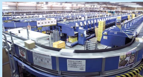
トレー式高速自動仕分け装置「リニースト」。衣料品、雑貨、食品など多様な商品形状に対応。高速かつ静粛・安全・高信頼性を特長に、さまざまな物流現場で活躍しています。
