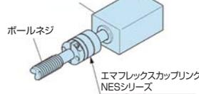
「エマフレックスカップリングNESシリーズ」は本体ハブならびにスペーサ材質に超超ジュラルミンを採用し、外径寸法を小さく抑え無駄を省いた独自のデザインにより、可能な限りの低慣性モーメントを追求しています。これによりサーボモータ駆動の高加減速運転に対応するだけでなく、消費電力を抑えたエコドライブを実現することができます。
